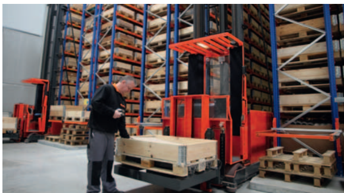
Het smallegangmagazijn bevat voornamelijk pallets die vanwege de opslagdichtheid zijn onverdeeld in vakken
