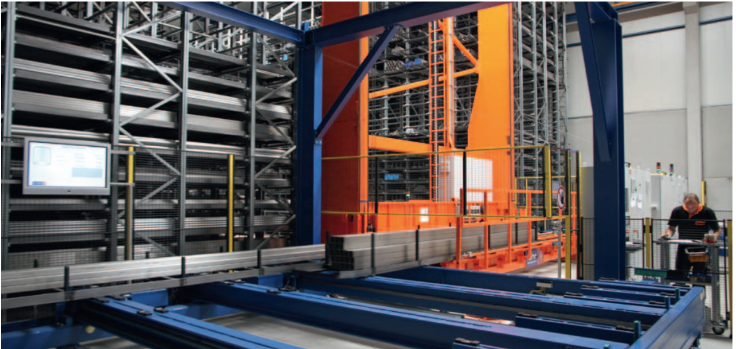
De 7 meter brede oranje kraan biedt ruimte aan twee ladingdragers met buizen
